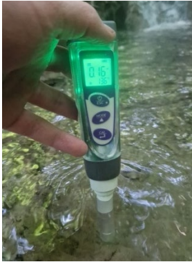
Abb. 27: Messung der elektrischen Leitfähigkeit: (Waterproof Tester COND 5, Artikel-Nr. HPC9.1, Hersteller: DOSTMANN electronic GmbH, Waldenbergweg 3b, D-97877 Wertheim-Reicholzheim, Deutschland)
