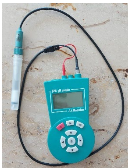
Abb. 25: Messung der Wassertemperatur und des pH-Wertes: (Metrohm 826 pH mobile, Artikel-Nr. 1.826.0010, Serien Nr. 9.1234567, Hersteller: Metrohm AG, CH-9100 Herisau, Schweiz)
