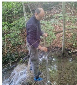
Abb. 26: Messung der Transparenz: (Acrylglas-Röhre, 130 mm lang, Innendurchmesser 46 mm, Plastic-Haus AG, Artikelnummer 1224, Gummistopfen Durchmesser 46 mm, Plastic-Haus AG, Artikelnummer 9121, Secchi-Scheibe angefertigt von A. Bircher) [26].
