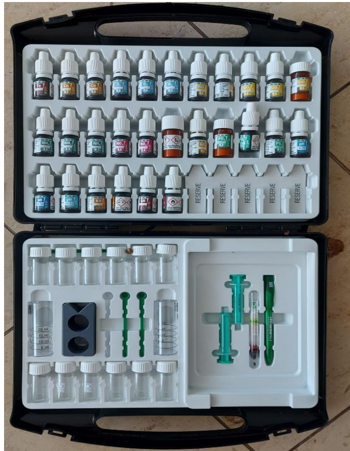
Abb. 24: Messung des Sauerstoffgehalts, Nitratgehalts, der Gesamthärte GH und der Karbonhärte KH: Hierfür gebraucht wurde folgender Koffer (JBL PROAQUATEST COMBISET Plus NH 4 , Artikel-Nr. 8700, Serien-Nr. 5.9876543, Hersteller: JBL GmbH & Co. KG, 67141 Neuhofen, Deutschland)
